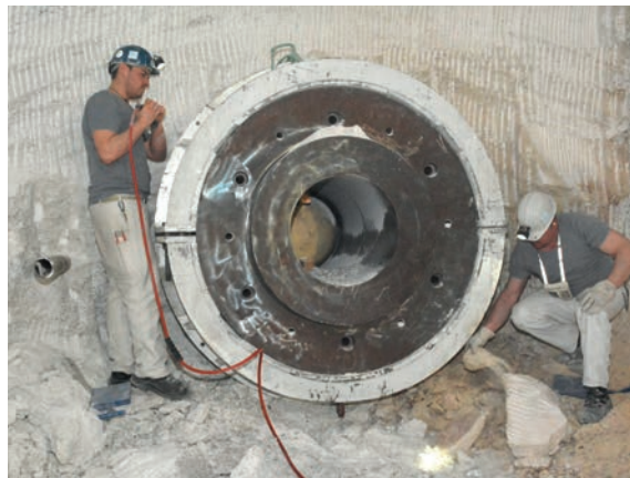
Das Segment ist außen vom Salz befreit. BBM-Mitarbeiter befestigen den Stahlring. In der Mitte befand sich der Erhitzer.
